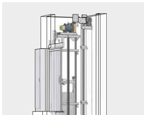
Maschinenraumlos (MRL) Antrieb im Schachtkopf
